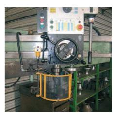
Protección para taladro radial. Pantalla de Ø 300, 350, 400, 450mm. Soporte de 500mm de altura.
