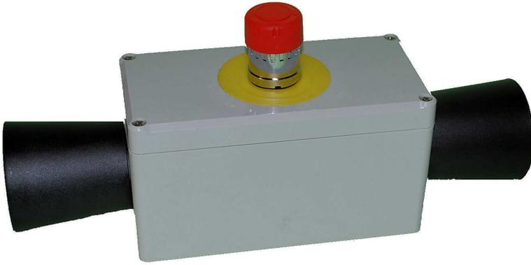
El sistema de Mando Bimanual formado por una consola bimanual y el módulo autocontrolado JSBR4 o el PLC de seguridad PLUTO asegura la protección del operario, obligando a que sus dos manos estén ocupadas mientras dure el movimiento peligroso de máquinas con un PI e , categoría de seguridad 4 según EN ISO 13849-1, es decir es de Clase IIIB según EN ISO 13851.
